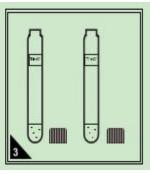
选择合适量程的预制试剂,一支作为**空**白样,再根据待测水样的数量选择相同数量的预制试剂作为**待测样**,置于试管架上。
