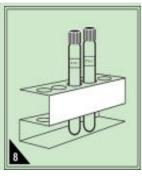
20 分钟消解时间结束,消解器进行降温,手拿管盖取出试管,放入试管架中置于通风处进行冷却,待试管降至室温左右方可进行测量。
