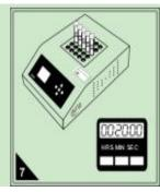
消解仪温度上 升至 165°C 后,依次放入 标记好的空白 样和待测样, 加热消解 20分 钟。
