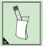
取出冷却好的试管样,用擦镜布或无毛屑的软纸擦干净试管外壁,放入水质检测仪内进行比色操作。
