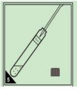
按步骤 4 的方法移取 2ml 待测水样加入到其他预制试剂的试管内,每只预制试剂对应一个待测水样。制成待测样。记录试管上的编码。
