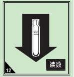
依次放入待测样,按检测 直接读取 COD 浓度 (mg/L),期间无需拧开瓶 盖,必须保证液面中间为 澄清状态,如有絮状沉淀 应待沉淀完全沉下或采用 离心操作,否则读数偏差 较大。
