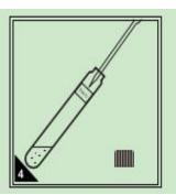
使用移液管或移液枪准确移取 2mL 纯净水水加入到预制试管内,制成空白样(使用移液管时需要贴壁,注意不要深入试管口太深,以防带出试管内的颗粒或液体)。
