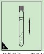
拧紧管盖,上下摇晃 试管,使试管底部的 沉淀物离开管底与 水样充分接触(此时 试管内试剂反应会 有热量产生,建议拿 握瓶盖部分以防烫 伤)。
