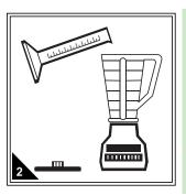
将待测水样按预处理 要求进行混匀等操作。 对于悬浮物较多的水 样,应进行搅拌等匀质 化处理,以减小取样误 差
